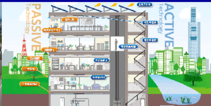
ZEBの概念図〔出典：環境省ホームページ （ http://www.env.go.jp/earth/zeb/about/index.html ）に 掲載の画像を加工して作成〕
