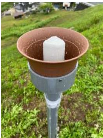
縦型オールインワン型 IoT 降雨計（拡大）
