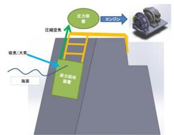
③ 今後：実証実験を通じて、より効率よく波のエネルギーから圧縮空気を製造する波力回収装置を開発することで、波力発電システムの製品化を目指す。
