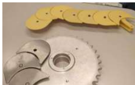
寿司コンベアチェーン （初期型：ステンレス素材） （現在：樹脂素材）
